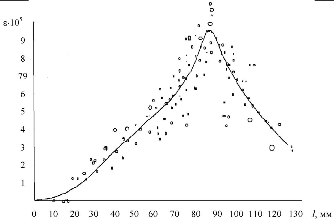
Залежність максимальних деформацій від відстані від точки епіцентрту вибуху по твірній циліндричної оболонки
