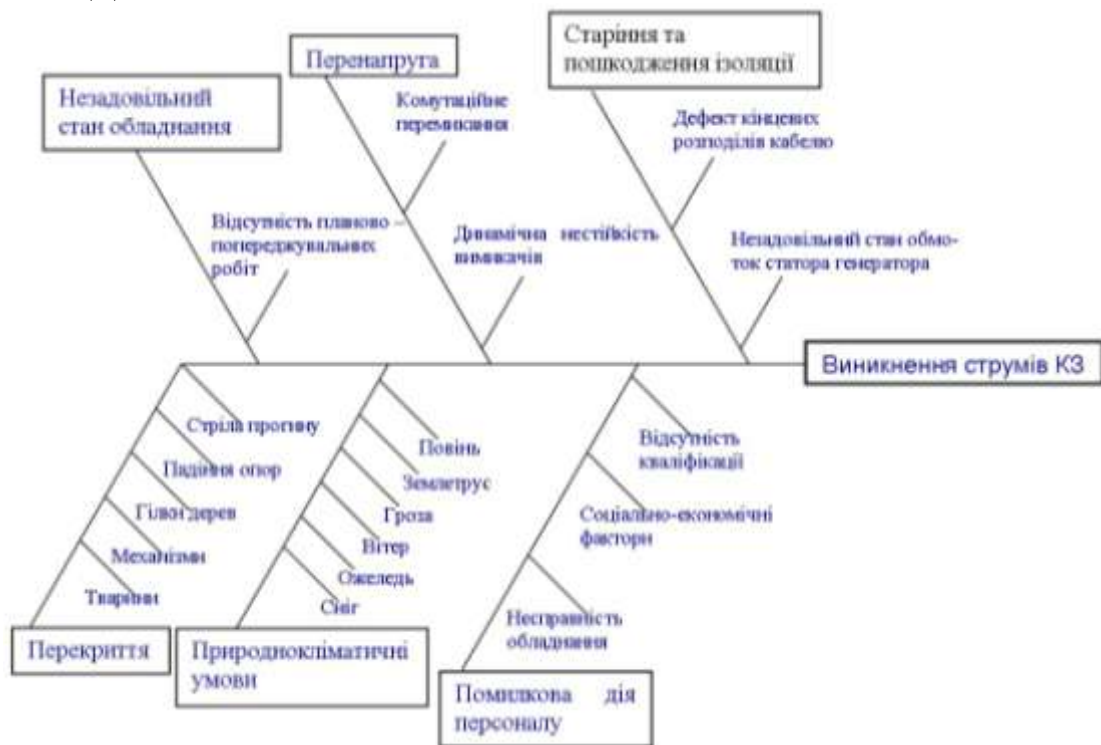
Рис. 1. Схема причинно – наслідкових зв'язків виникнення струмів КЗ
