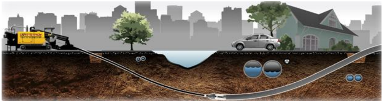
Рис. 1. Схема проведення горизонтально направлено буріння
