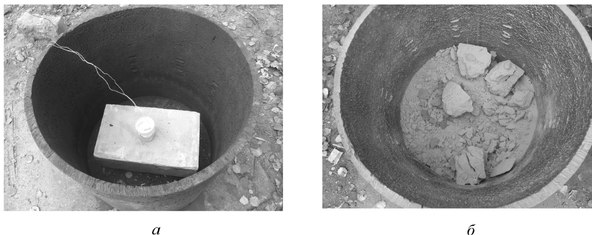
Рис. 3. Общий вид экспериментальной установки ( а ) и результат взрыва ( б )
