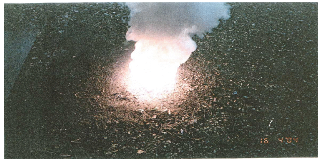
Рис. 2. Визначення займистості КРУ: а – горіння стандартного зразка: тирси дуба з броматом калію у співвідношенні 1:1; б – горіння тирси дуба з КРУ у співвідношенні 1:1
