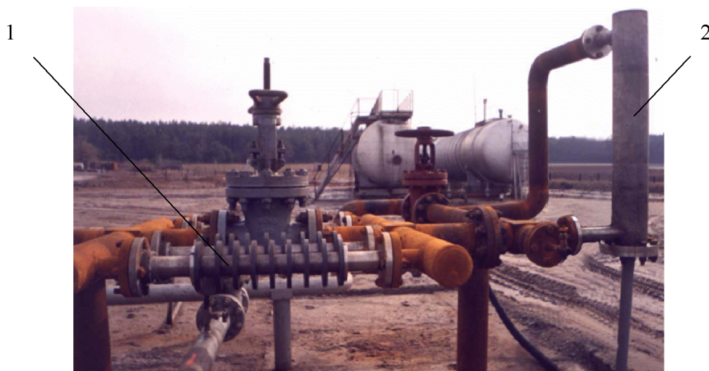
Рис. 3. Магнітно-ультразвукова система підготовки та очищення води для нагнітання в продуктивні горизонти продуктивністю до 1000 м 3 /добу: 1 – блок знакозмінного магнітного поля; 2 – генератор акустичних коливань
