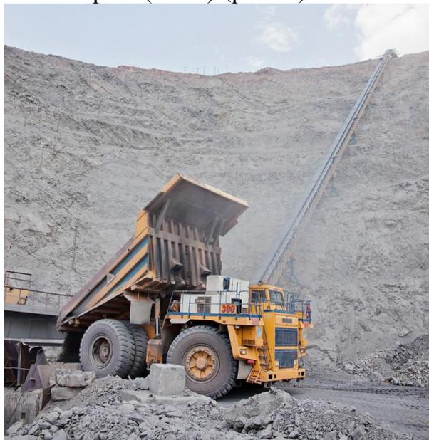
Рис. 1. Транспортировка горной массы крутонаклонным конвейером после первичного дробления в карьере
