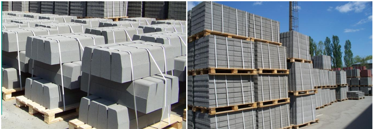
Рис. 4. Будівельна продукція виготовлена з відходів щебеню на МКДЗ
