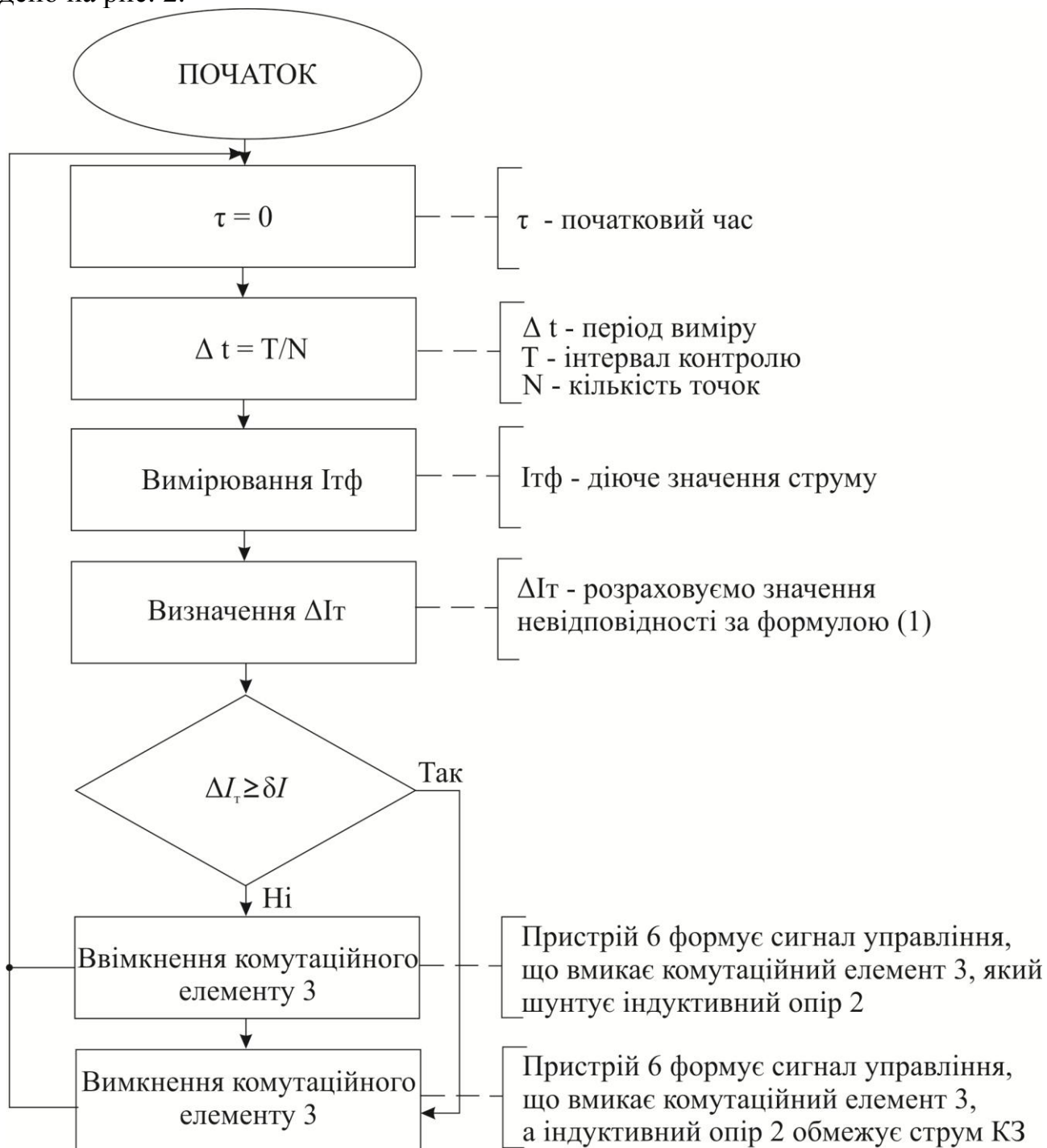
Рис. 2. Алгоритм роботи аналізатора
