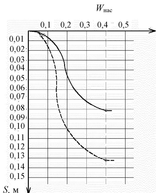
Вплив вологості  $W$  на деформацію лесового ґрунту: суцільні лінії при  $T = 20^\circ\text{C}$ ; пунктирні лінії при  $T = 60^\circ\text{C}$
