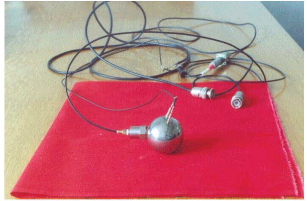
Рис. 2 Датчик-шар с установленным для тарировки датчиком ускорения 4384 фирмы V&K
