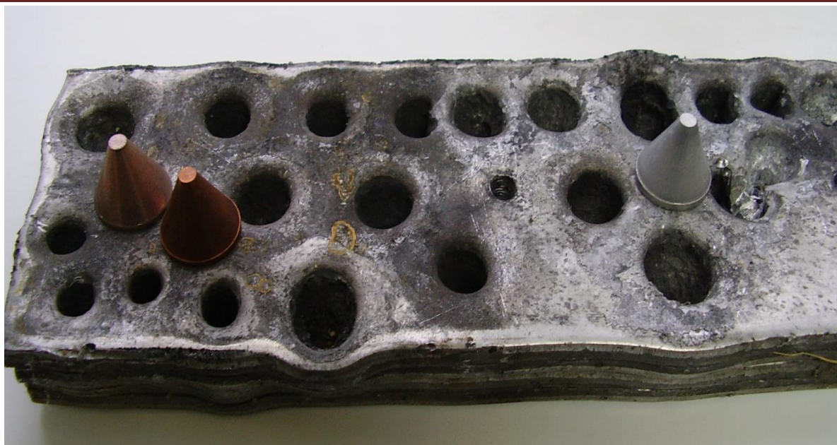
Рис. 5. Результати кумулятивного пробиття мішені із АМЦ-н мідними (малі діаметри) та алюмінієвими струменями (найбільші діаметри)
