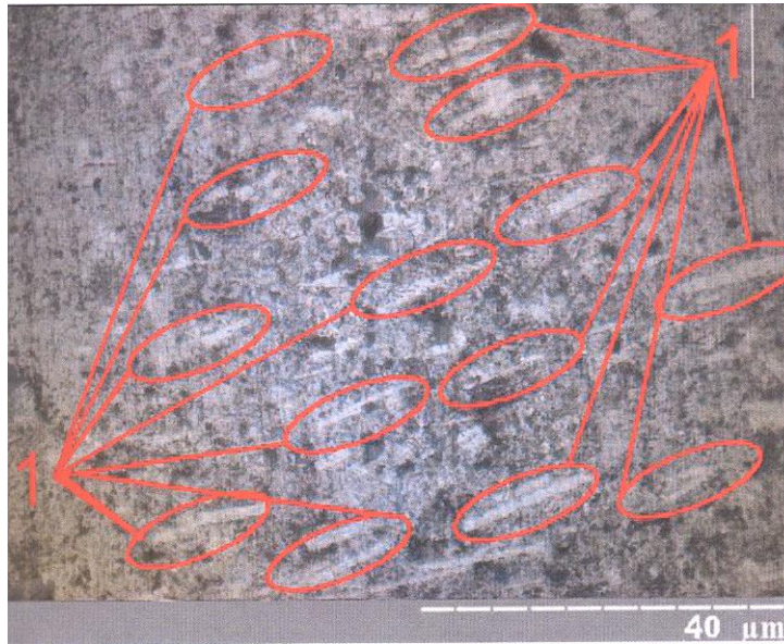
Рис. 2. Фото зразка граніту після обробки магнітогідрокавітаційним навантаженням [6]
