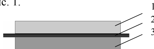
Рис. 1. Схема розташування зразка захисного матеріалу: 1 – прилад СРП-68-1; 2 – зразок захисного матеріалу; 3 – прилад ДРГ-1Т1
