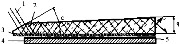
Рис. 4. Прилад для нанесення аморфної плівки на поверхню виробу із збільшеною довжиною поверхні: 1 – лазерний промінь; 2 – оптичний клин; 3 – плівка з матеріалу, схильного до аморфізації; 4 – виріб; 5 – шар нанесеного аморфного матеріалу
