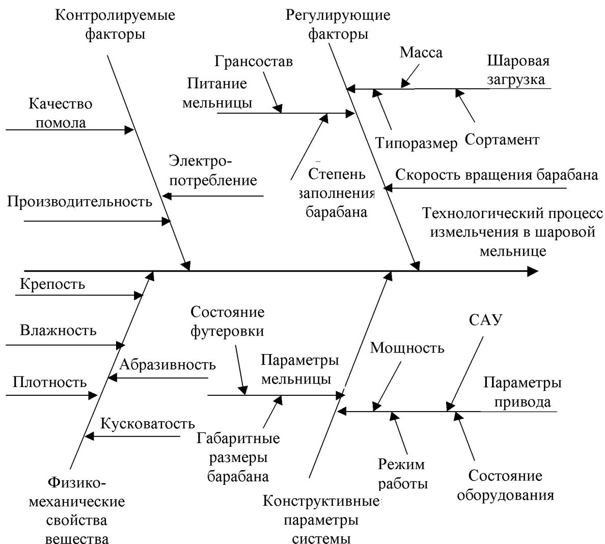
Рис. 2. Факторное поле шаровой мельницы (диаграмма Исикавы)
